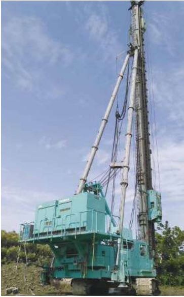
クローラ型三点支持式杭打機
