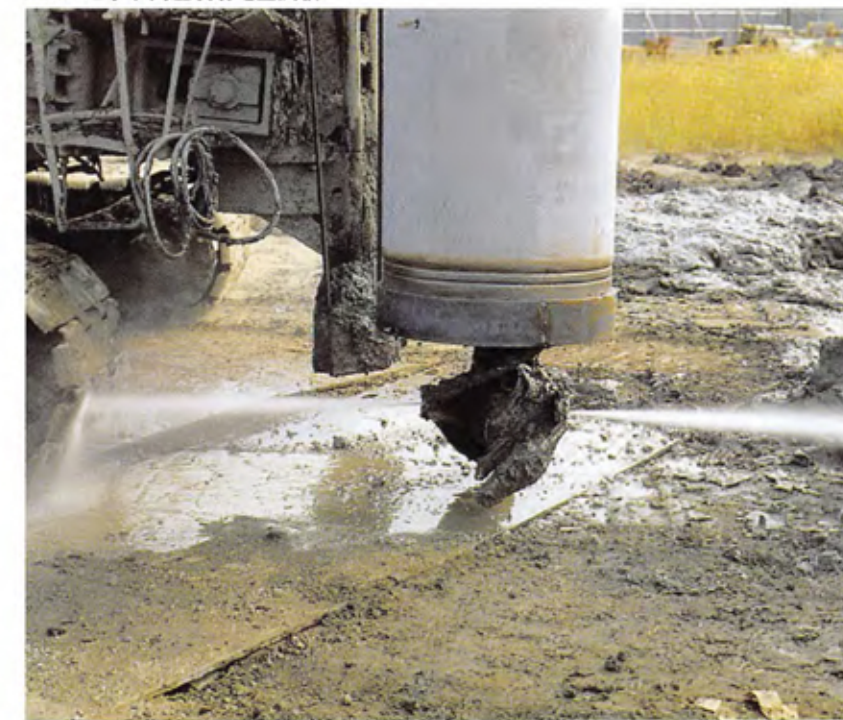
▼STJビット高圧噴射地上試験
