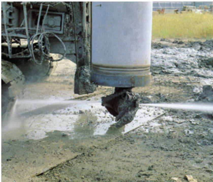
▼STJビット高圧噴射地上試験
