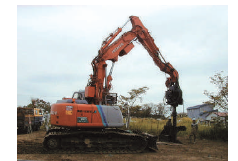
傾斜地などでの施工に適したリーダーレス施工機など、さまざまな条件に対応する施工機械を用意
